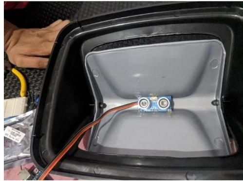
Gbr. 3 Pengujian sensor ultrasonik
